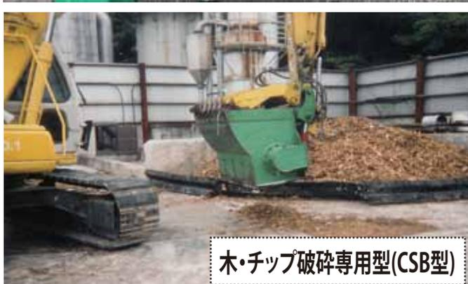
両刃式の固定刃はダブル構造により破碎性能を向上
