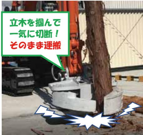
ノギリ刃 切断      ノギリ刃 収納      フォーク 作業!
