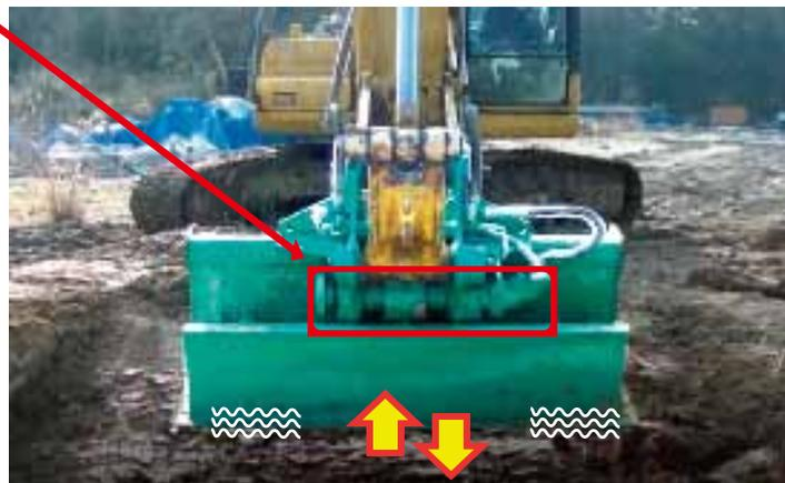
バケット底部に角度をつけて振動板の能力がUP!
