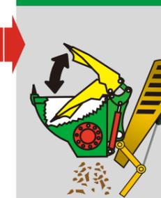
両刃式の固定刃はダブル構造により破碎性能を向上
