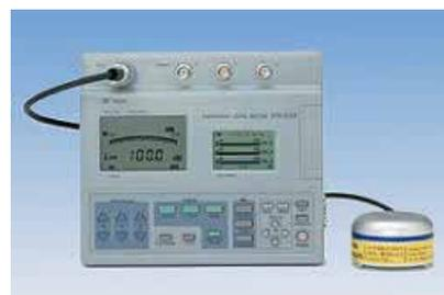
振動レベル計(VM-53A) 振動ピックアップ(PV-83C)
