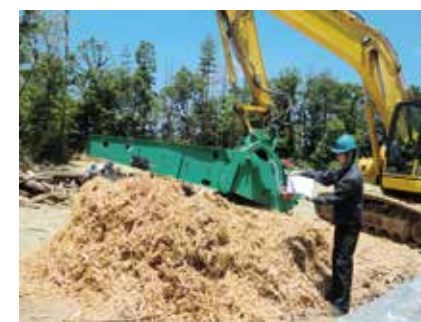
A型刃を装着したのが バケットチッパー A型
