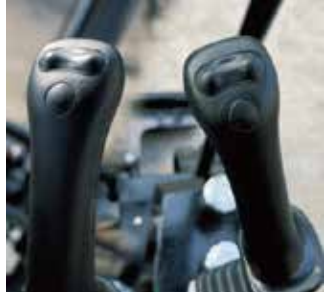
レバーで操作 構造は簡単で寿命が長い
