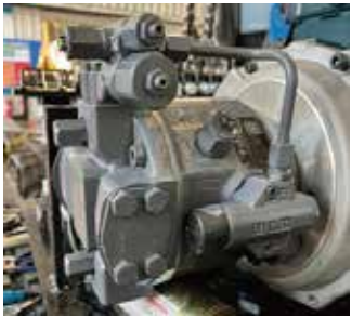
油圧ポンプで動作がなめらか エンジン温度が低く油節約
