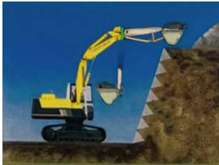
建築基礎根切り作業
